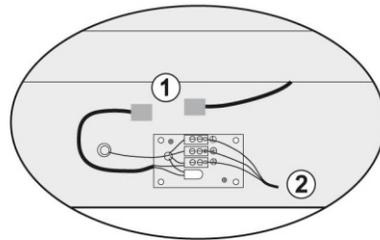
Verbindung der Lampenkabel mit den Anschlußkabeln
